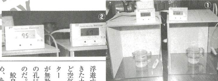
ビニールクロスの部屋(左)と珪藻土の部屋(右)を再現し、お湯の入ったビーカーを入れ、20分後に温度を測った
